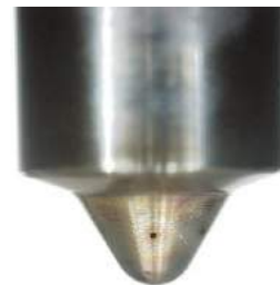
洗浄後の噴孔部
