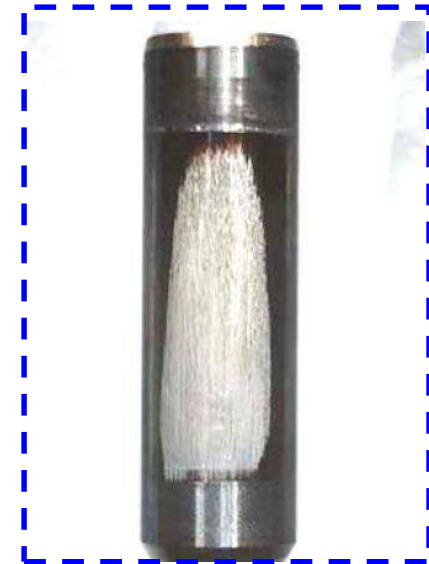
磨耗したニードル表面
